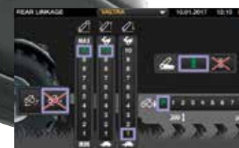
9-palcová dotyková obrazovka, intuitivní způsob nastavení pomocí velkých zobrazovacích prvků a snadno pochopitelných symbolů.
