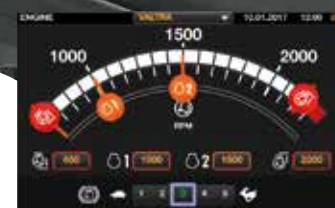
Upravování nastavení posouváním prstem na požadovanou hodnotu a automatické uložení do paměti.
