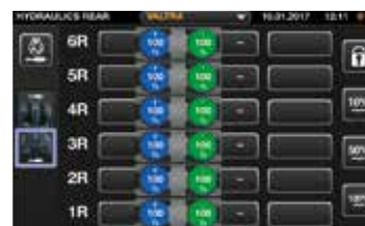
Nastavení hydraulických okruhů (čas a průtok). Volba ovládacích prvků hydraulických okruhů předního a zadního tříbodového závěsu a čelního nakladače.
