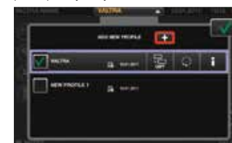
Pro jednotlivé řidiče a pracovní operace lze snadno vytvářet profily. Nastavení ve vybraném profilu se dají jednoduše upravit a všechny změny se uloží do paměti.
