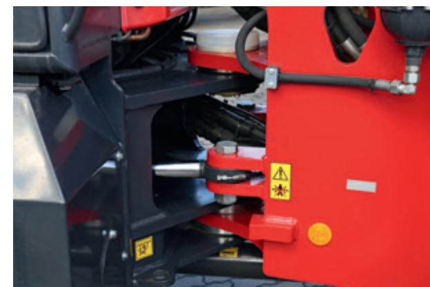
Kloubové řízení je velmi výkonné a bezúdržbové dva válce řízení umožňují přesné ovládání
