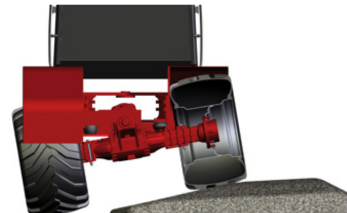
zadní výkyvná náprava poskytuje nejlepší stabilitu volitelně: elastomerové odpružení- ještě bezpečnější a pohodlnější provoz
