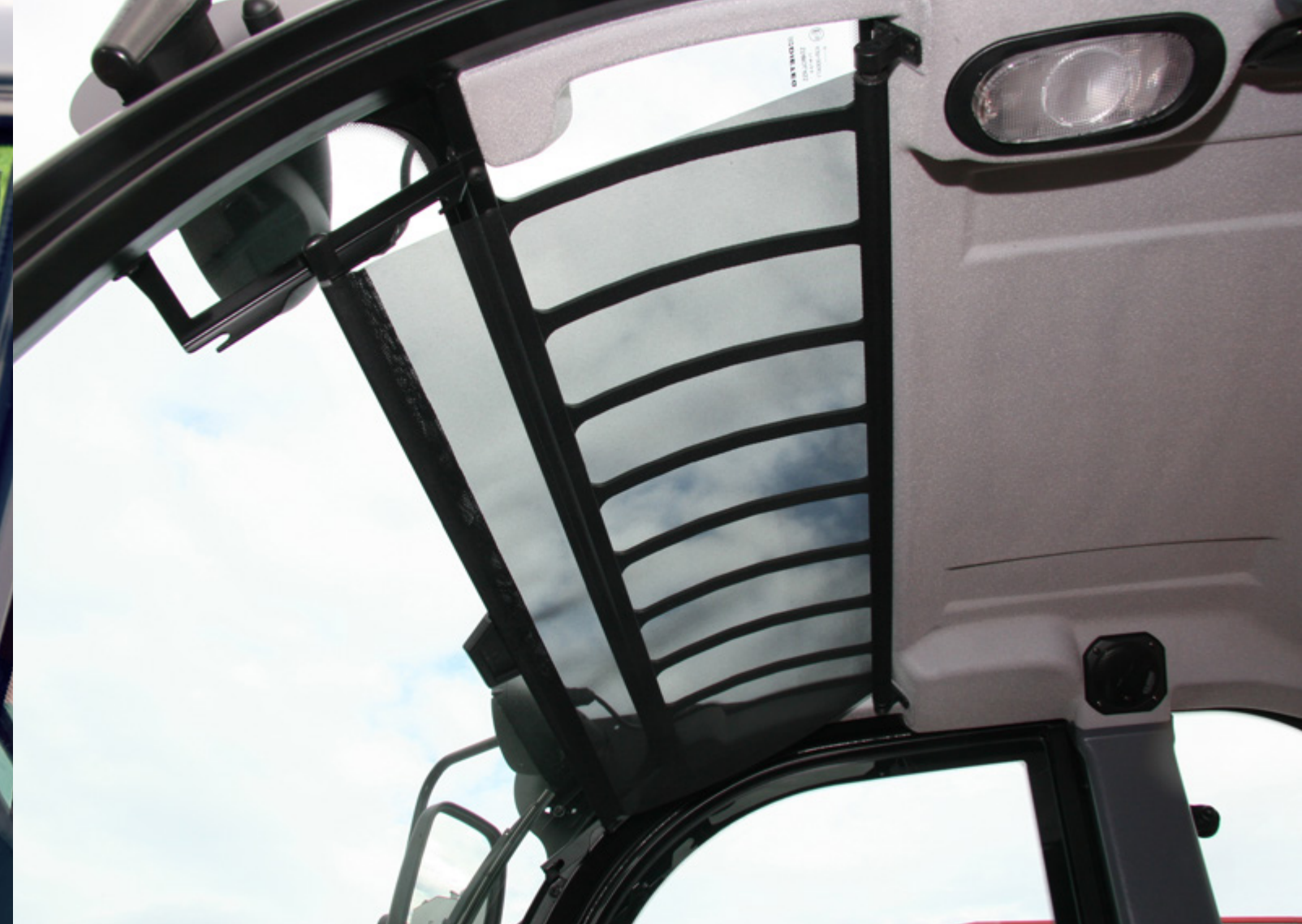
výborný výhled vzhůru, stahovací průhledné stínítko proti slunci
