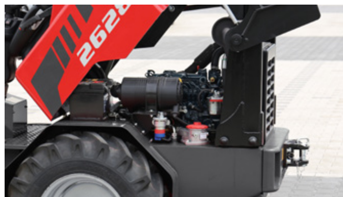
kapota motoru se otvírá směrem dopředu, a tak jsou všechna servisní místa snadno přístupná z obou stran stroje.
