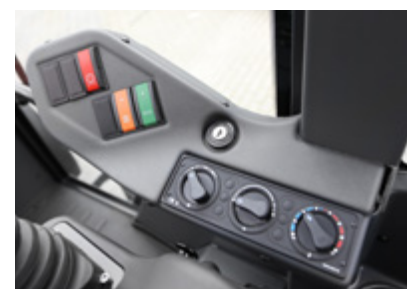
nový panel: spínací skříňka zapalování, snadno dostupné ovládání topení a klimatizace (opt)
