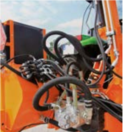
Napájecí hydraulický systém včetně rozdělovače - výkonný a odolný.
