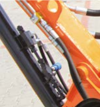
Hydraulická závora hlavního válce včetně nastavitelného škrticího ventilu.
