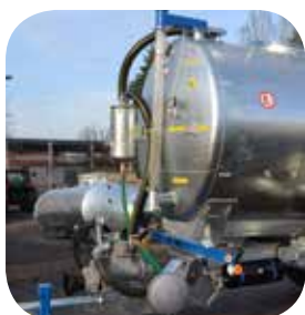
Plnicí vývod 2" + plastový ventil
