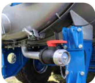
Plnicí vývod 2" + plastový ventil
