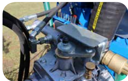
Hydraulické ovládání kompresoru
