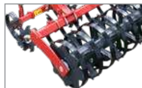
Actiflex ø 580 mm - 160 kg/m
