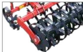
Actiflex Ø 580 mm - 160 kg/m
