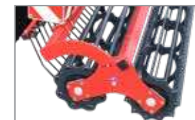
Dvojitý prutový ø 400 mm (trubkový/ploché profil) - 160 kg/m
